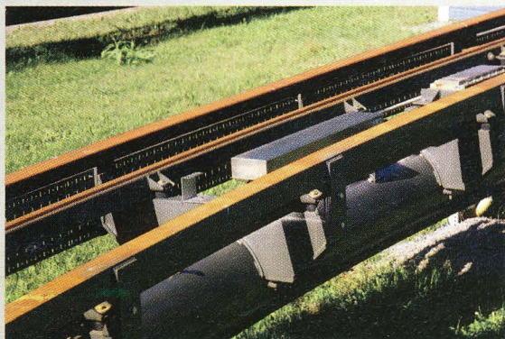
MOTOR: Vectus har valgt å legge lineær-motorene i skinnegangen. Dermed blir strømvakter unødvendig og vinterdrift blir enklere og sikrere.
