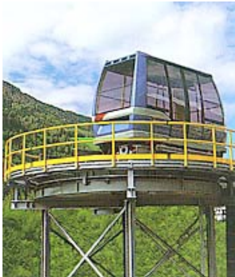
Figur 3.24. Vändskiva för kabelbana
